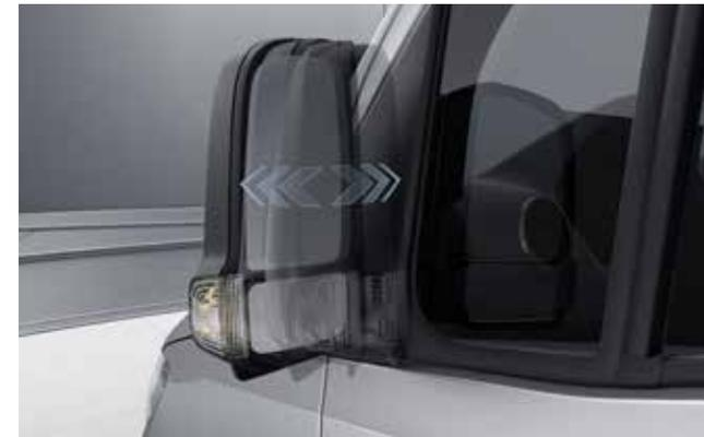
Наружные зеркала заднего вида с электроприводом и функцией складывания в сложенном состоянии лучше защищены от повреждений при маневрировании в стесненных условиях или во время парковки.
