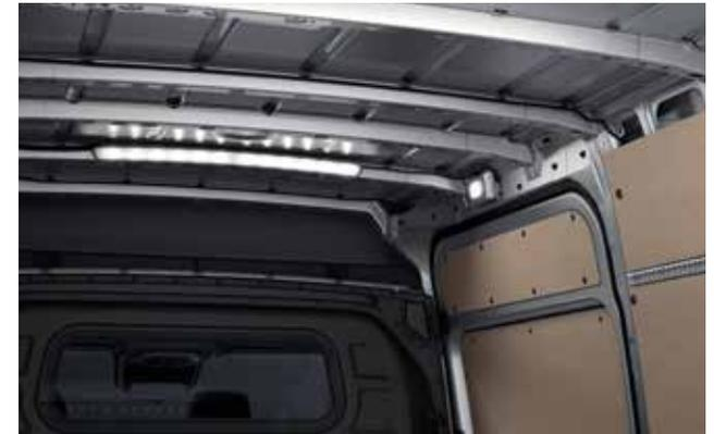
Две светодиодные ленты под крышей освещают грузовое пространство практически без теней и облегчают ориентацию при погрузке/разгрузке.
