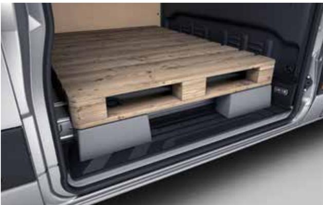
Упоры для поддонов в пороге раздвижной двери стабилизируют груз в области двери и особенно целесообразны при транспортировке груза на поддонах или в решетчатых контейнерах.
