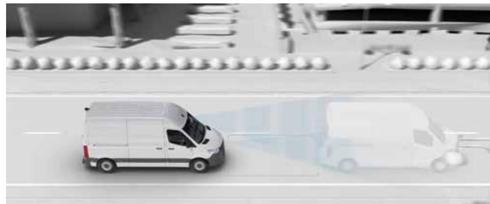
Активная система экстренного торможения может способствовать предотвращению аварий с идущими впереди автомобилями и пересекающими дорогу пешеходами или смягчать последствия аварии.
