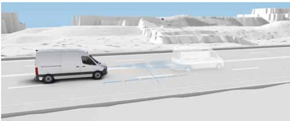
Активная система поддержания дистанции DISTRONIC поддерживает установленную водителем дистанцию до идущего впереди автомобиля и снимает с водителя часть нагрузки при движении по автомагистрали или в дорожном заторе.
