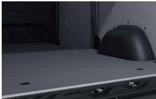
Оптимизированный по массе пластиковый пол имеет ровную поверхность, на нем удобнее размещать грузы и его легче мыть, по сравнению с деревянным полом преимущество в весе составляет около 18,5 кг<sup>2</sup>.
