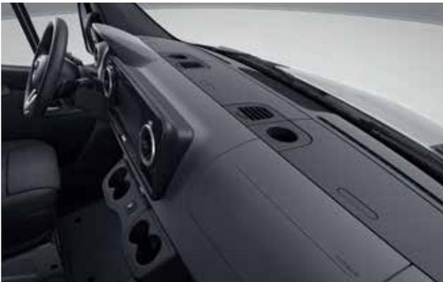
Во время движения вещевые отделения с откидными крышками слева и справа от приборной панели обеспечивают возможность надежного хранения планшета, документов, ключей, кошелька и других вещей.
