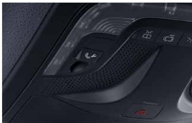
Быстрый вызов помощи в случае неисправности – одним нажатием кнопки: Служба управления неисправностями установит голосовую связь с Customer Assistance Center (CAC) и организует быструю помощь на месте.
