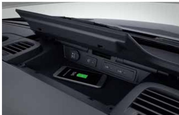
Благодаря беспроводной системе зарядки мобильные устройства с поддержкой стандарта Qi 1.2 или устройства, которые могут быть дооснащены соответствующим образом, могут просто заряжаться на средней верхней полке центральной консоли.
