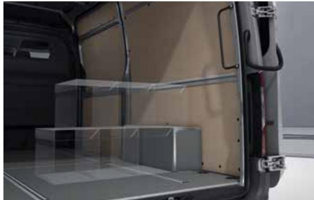
Деревянная обшивка модульных брызговиков улучшает возможности размещения груза в грузовом отделении и защищает металлический лист от повреждения.
