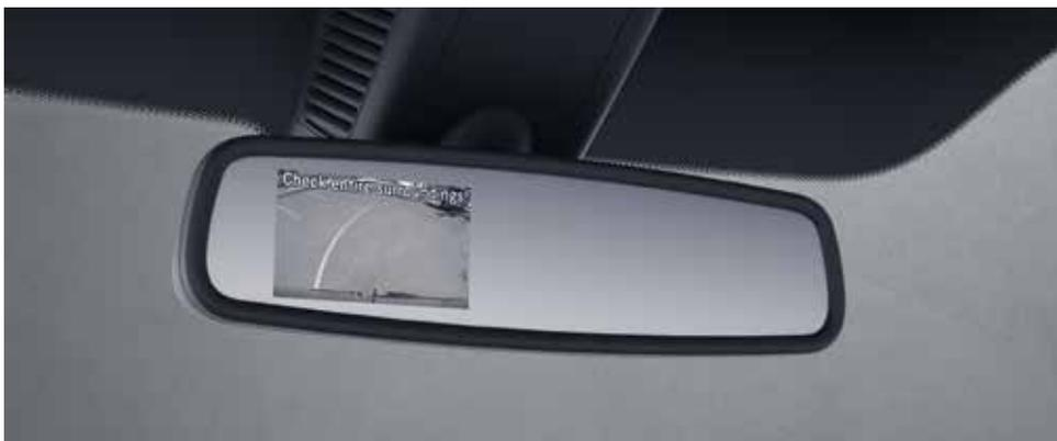
Камера заднего вида с индикацией на внутреннем зеркале заднего вида позволяет наблюдать за зоной позади автомобиля и повышает безопасность движения задним ходом.
