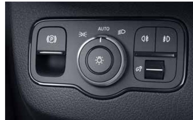
Управление электрическим стояночным тормозом осуществляется нажатием кнопки, благодаря отсутствию рычага стояночного тормоза облегчается проход в заднюю часть салона.
