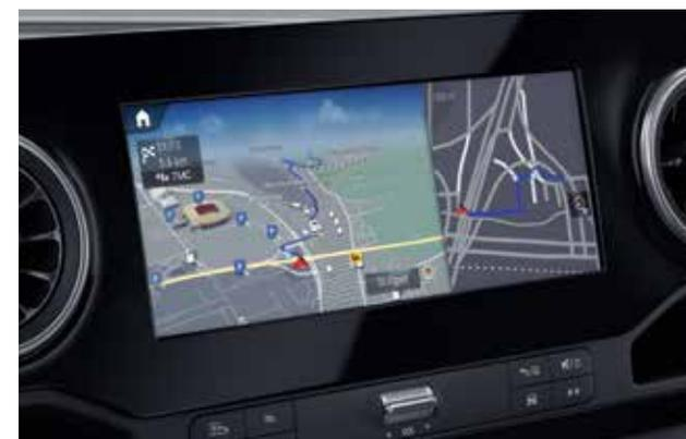
Благодаря этому оборудованию мультимедийная система MBUX (Mercedes-Benz User Experience) с экраном 26 см (10,25 дюйма) превратится в полноценную навигационную систему, которая обеспечивает навигацию к цели, делает поездки менее утомительными и позволяет быстрее достичь цели.
