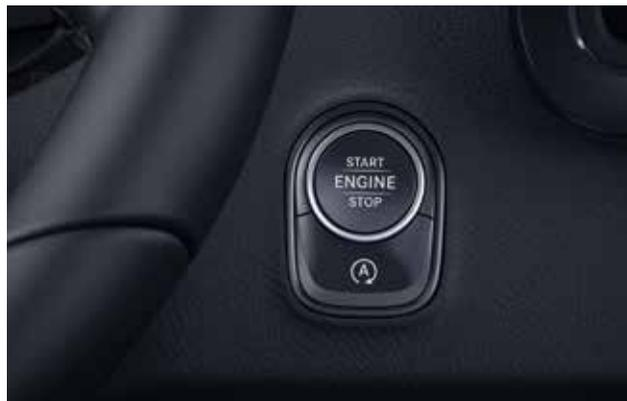
Двигатель запускается простым нажатием кнопки: Система санкционированного доступа KEYLESS-START позволяет запускать двигатель одним нажатием кнопки в замке зажигания.
