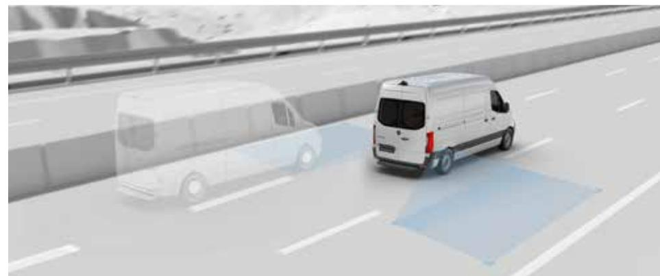
Активная система контроля слепых зон с системой предупреждения об объектах, движущихся в поперечном направлении позади автомобиля, помогает с помощью визуальных и звуковых предупреждающих сигналов избежать аварий при смене полосы, при выезде из парковки задним ходом или при выходе из автомобиля.
