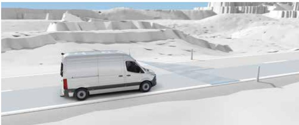
Активная система удержания полосы движения помогает заметить неумышленный сход с полосы, предупредить водителя и при необходимости вернуть автомобиль на нужную полосу, задействовав систему торможения.
